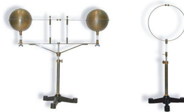
FIGURE 34 Une des premières antennes émettrices (à gauche) et réceptrices complètes (à droite) d'ondes électromagnétiques.
