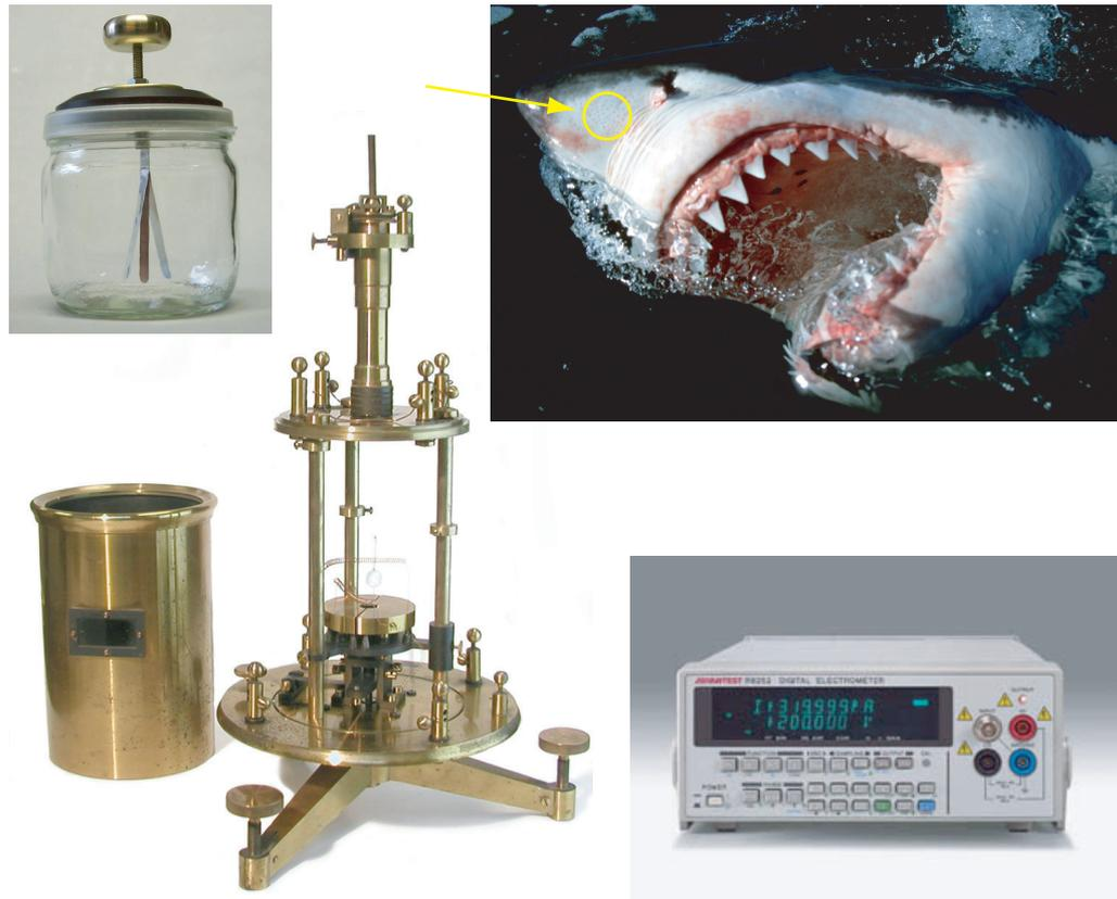
**FIGURE 7** Divers électromètres : un électromètre artisanal basé sur un pot de confiture, un ancien électromètre Dolezalek (ouvert) de haute précision, les ampoules de Lorenzini d'un requin, et un électromètre numérique moderne. (© Harald Chmela, Klaus Jost - [www.jostimages.com](http://www.jostimages.com), Advantest)
