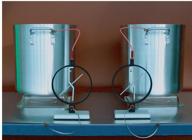
**FIGURE 8** Un dispositif simple pour confirmer la conservation de la charge électrique : si un chiffon frotté est déplacé du premier pot vers le second, la charge prélevée à partir du premier pot est transférée au second, comme l'indiquent les deux électromètres. (© Wolfgang Rueckner)
